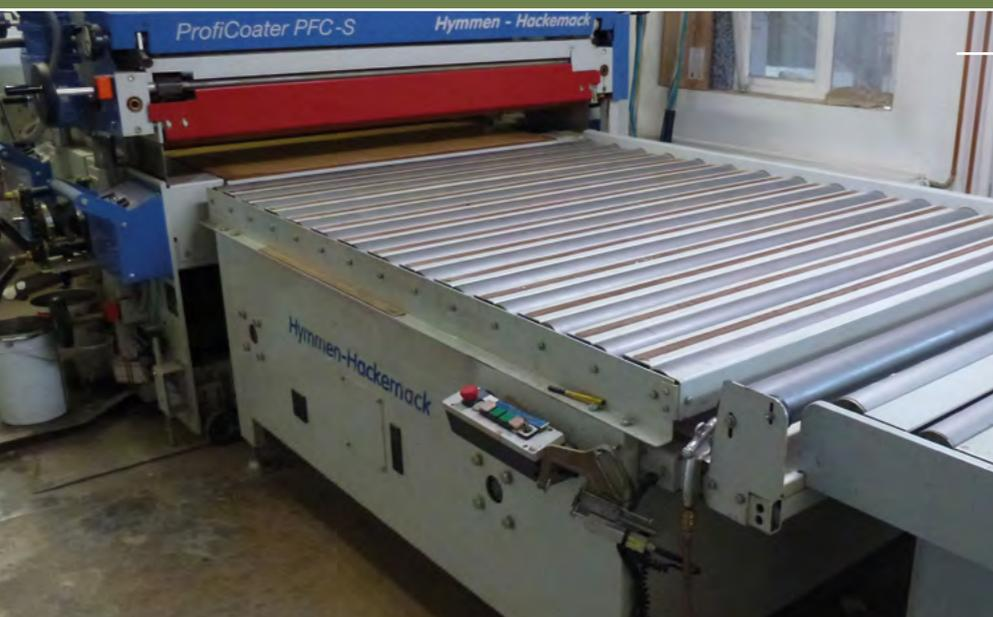
Die UV-Lackieranlage sorgt für einen lösemittelarmen Lackaufbau.
